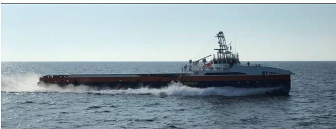
Prototyp eines unbemannten Überwasserschiffes
