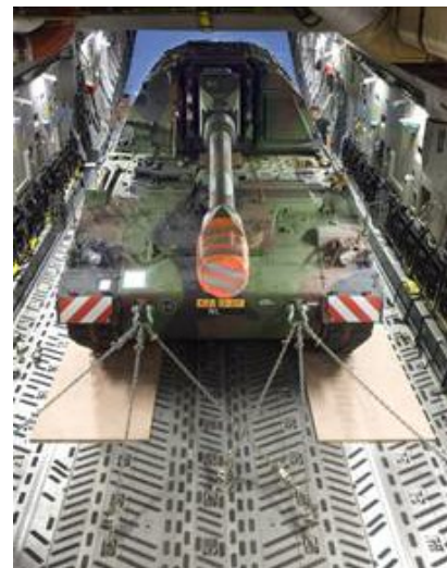
Links: Haubitze vor der Laderampe der C-17 Rechts: Haubitze im Laderaum der C-17, festgezurrt
