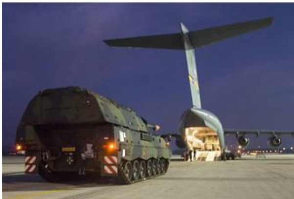
Links: Haubitze vor der Laderampe der C-17 Rechts: Haubitze im Laderaum der C-17, festgezurrt
