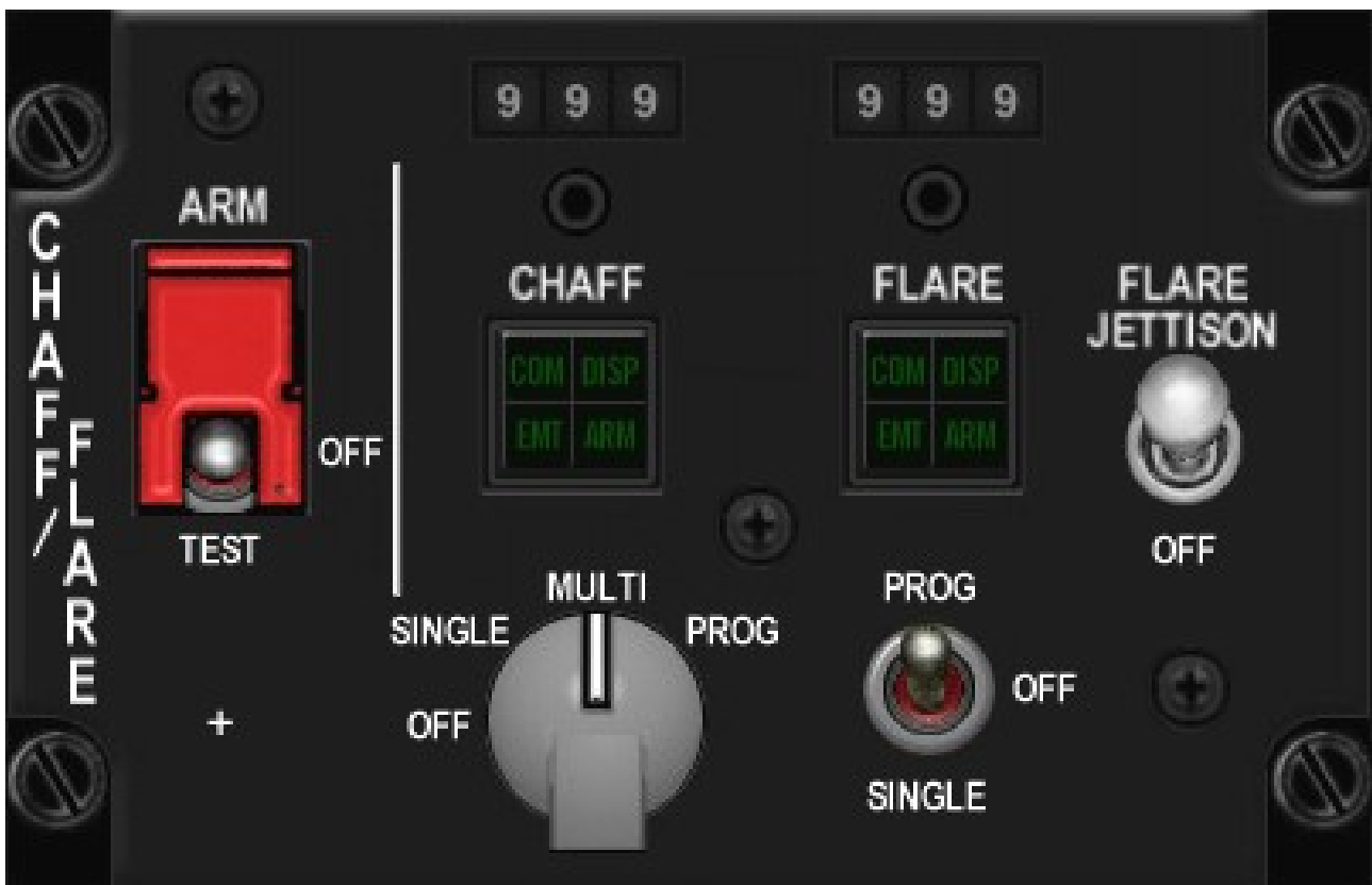
Zeichnung eines Chaff/Flare-Panels aus dem Cockpit einer F-16 (entnommen aus www.xflight.de )
