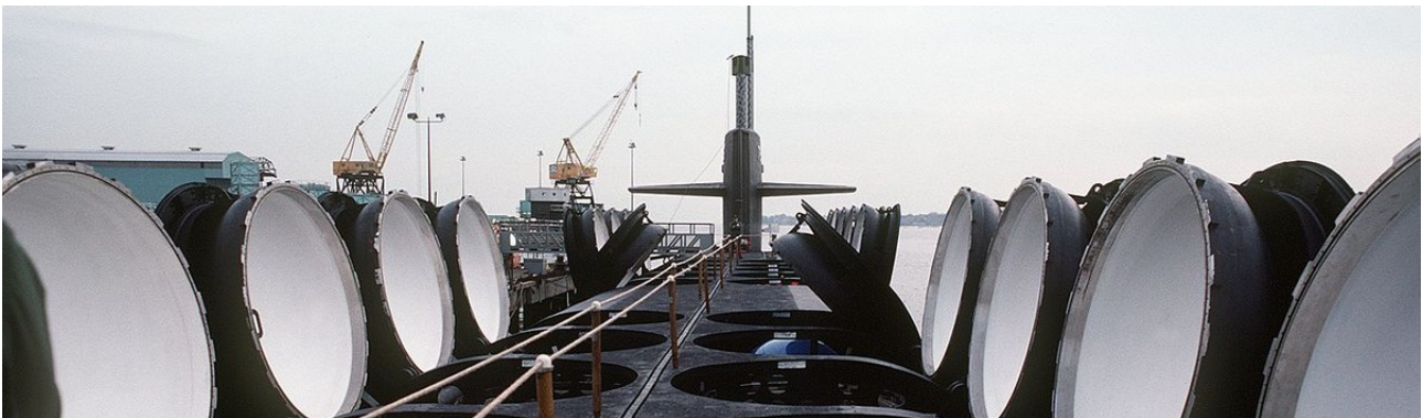
Geöffnete Schächte für Trident-Raketen auf einem US-U-Boot der Ohio-Klasse (Bildausschnitt entnommen aus https://de.wikipedia.org/wiki/Ohio-Klasse )
