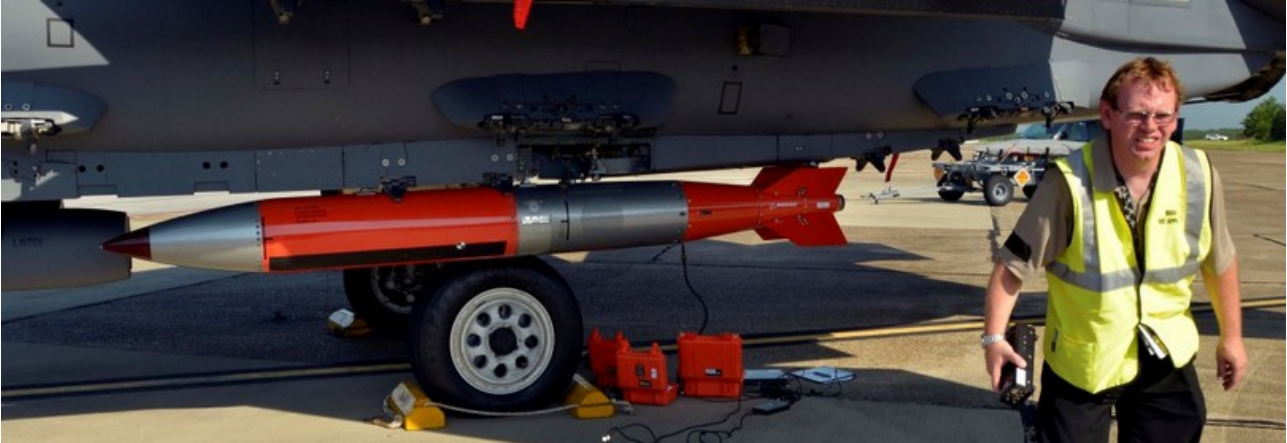
An einem Kampffjet des Typs F-15 hängende B61-12 Atombombe (Foto: Dan Sagalyn, entnommen aus http://www.pbs.org/newshour/updates/8b-nuclear-bomb-upgrade-looks-like/ )
