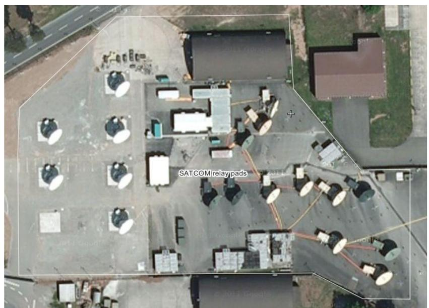
Auf dem in zwei Stufen vergrößerten Ausschnitt mit der Bezeichnung "SATCOM relay pads" auf Seite 1 unten, der einen relativ frühen Bauzustand wiedergibt, ist eine deutliche Zweiteilung zu erkennen. Auf der rechten Bildhälfte sind die mobilen Ground Control Stations / GCS des Provisoriums zu sehen, auf der linken Bildhälfte sind auf sieben fertig betonierten Standplätzen bereits sechs stationäre GCS montiert.
