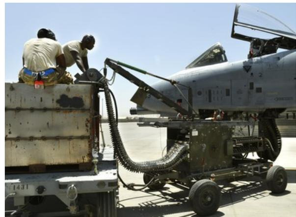
Eine in Afghanistan eingesetzte A-10 Thundelbolt wird mit 30-mm-Geschossen vom Typ PGU-13B HEI bestückt. Sie kann auch DU-Munition vom Typ PGU-14/B API verschießen. Weitere Infos dazu sind nachzulesen unter [http://www.gdots.com/MCA\\_30mmGAU8.html](http://www.gdots.com/MCA_30mmGAU8.html) .
