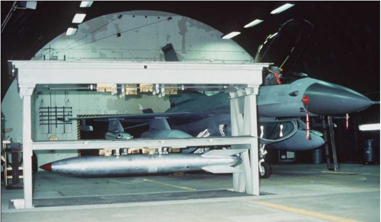
Das im Innern eines Flugzeugschutzbunkers aufgenommene Foto zeigt den aus der unterirdischen Lagerungsgruft ausgefahrenen Stahllift mit Aufhängevorrichtungen für vier Atombomben, eine Bombe des Typs B 61 und eine F-16, die zwei davon transportieren kann. (Quelle: http://www.nrdc.org/nuclear/euro/euro.pdf )
