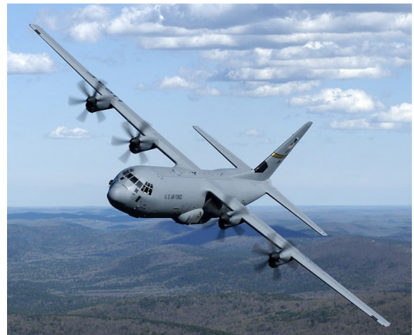
▲ C-130E mit 4 Propeller-Blättern an den Triebwerken C-130J mit 6 Propeller-Blättern an den Triebwerken ► (Fotos: Wikipedia)
