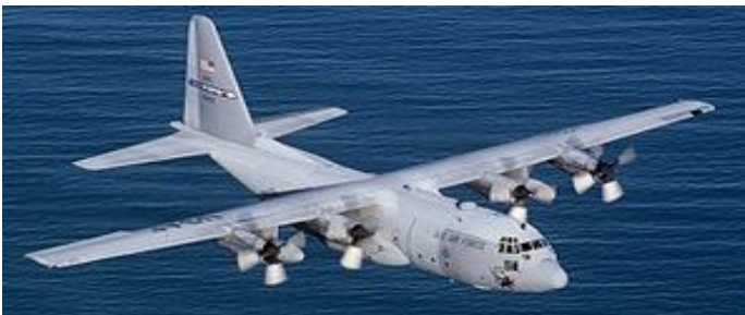
▲ C-130E mit 4 Propeller-Blättern an den Triebwerken C-130J mit 6 Propeller-Blättern an den Triebwerken ► (Fotos: Wikipedia)
