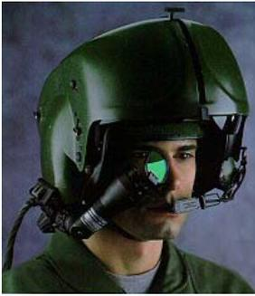
Die Zielerfassung erfolgt durch ein mit dem Helm der Piloten verbundenes Visiersystem IHADSS (Integrated Helmet And Display Sight System). Eine Kopfbewegung des Piloten in Richtung des zu erfassenden Ziels schwenkt den Zielerfassungslaser in die entsprechende Richtung. Gleichzeitig werden Informationen über das Ziel, zusammen mit Informationen über den Flugzustand des Hubschraubers in das Sichtsystem eingeblendet. ...
