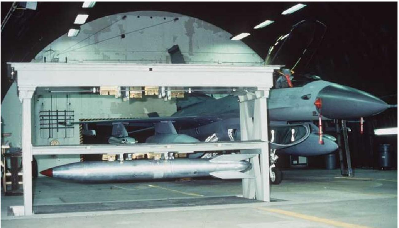
Im Innern eines Flugzeug-Schutzbunkers aus einer unterirdischen Waffenlagerungsgruft ausgefahrenes Lagerungsgestell, das insgesamt vier Bomben aufnehmen kann, jetzt aber nur eine B61-Atombombe enthält. Hinter dem Gestell steht eine F-16, die zwei dieser Atombomben tragen kann. (Entnommen aus: [www.nukestrat.com/us/afn/nato.htm](http://www.nukestrat.com/us/afn/nato.htm) )
